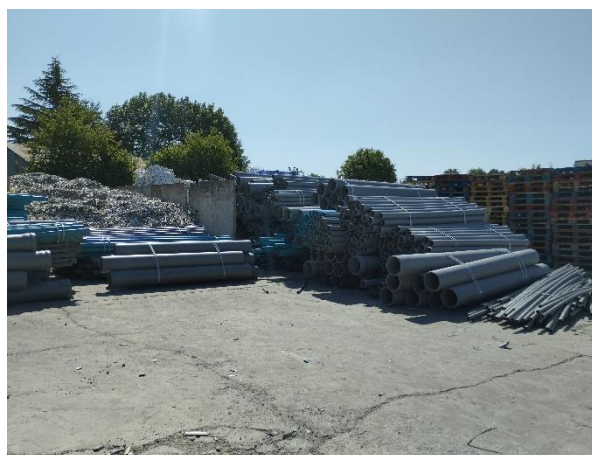
Figure 22 : Déchets et chutes avant broyage, tels qu'ils sont actuellement stockés
